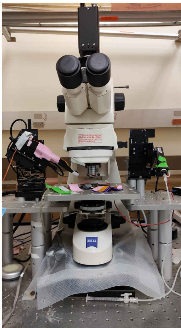
Figura 1. Microscopio óptico con contraste diferencial o infrarrojo
