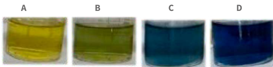
Figura 1. Imágenes de soluciones coloidales que contienen nanopartículas de plata sintetizadas con 1.2 (A), 0.9 (B), 0.6 (C) y 0.3 mL (D) de \text{NaBH}_4 .
